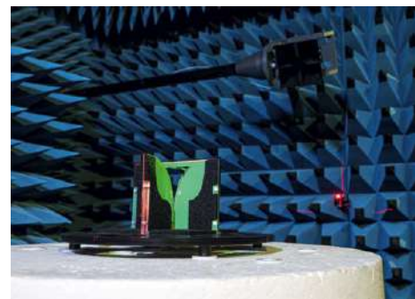
In der abgeschirmten Messkammer finden unter anderem WLAN-Messungen statt.
