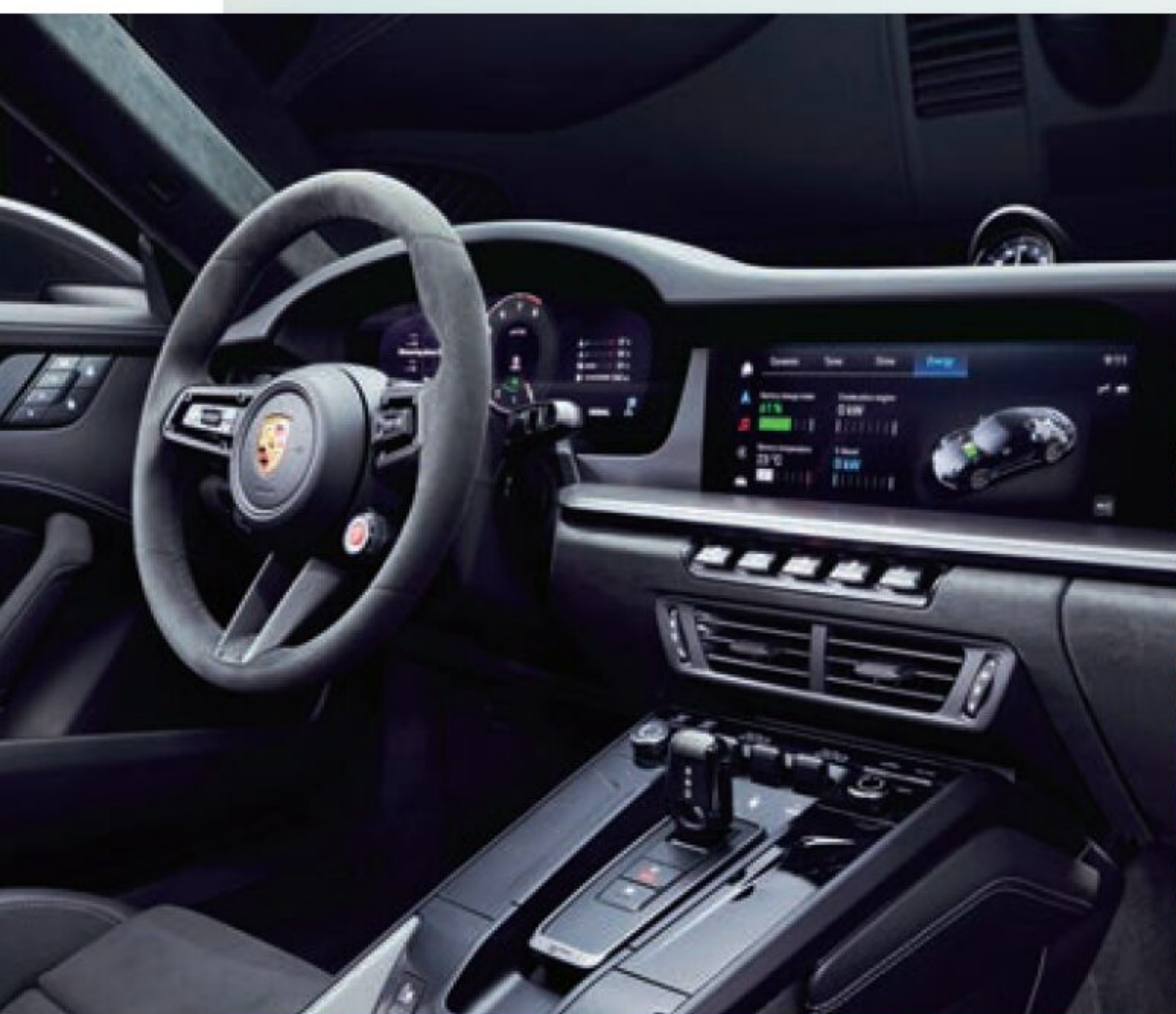
SCHON SCHICK: Der 911er-T-Hybrid hat ein volldigitales Kombiinstrument
