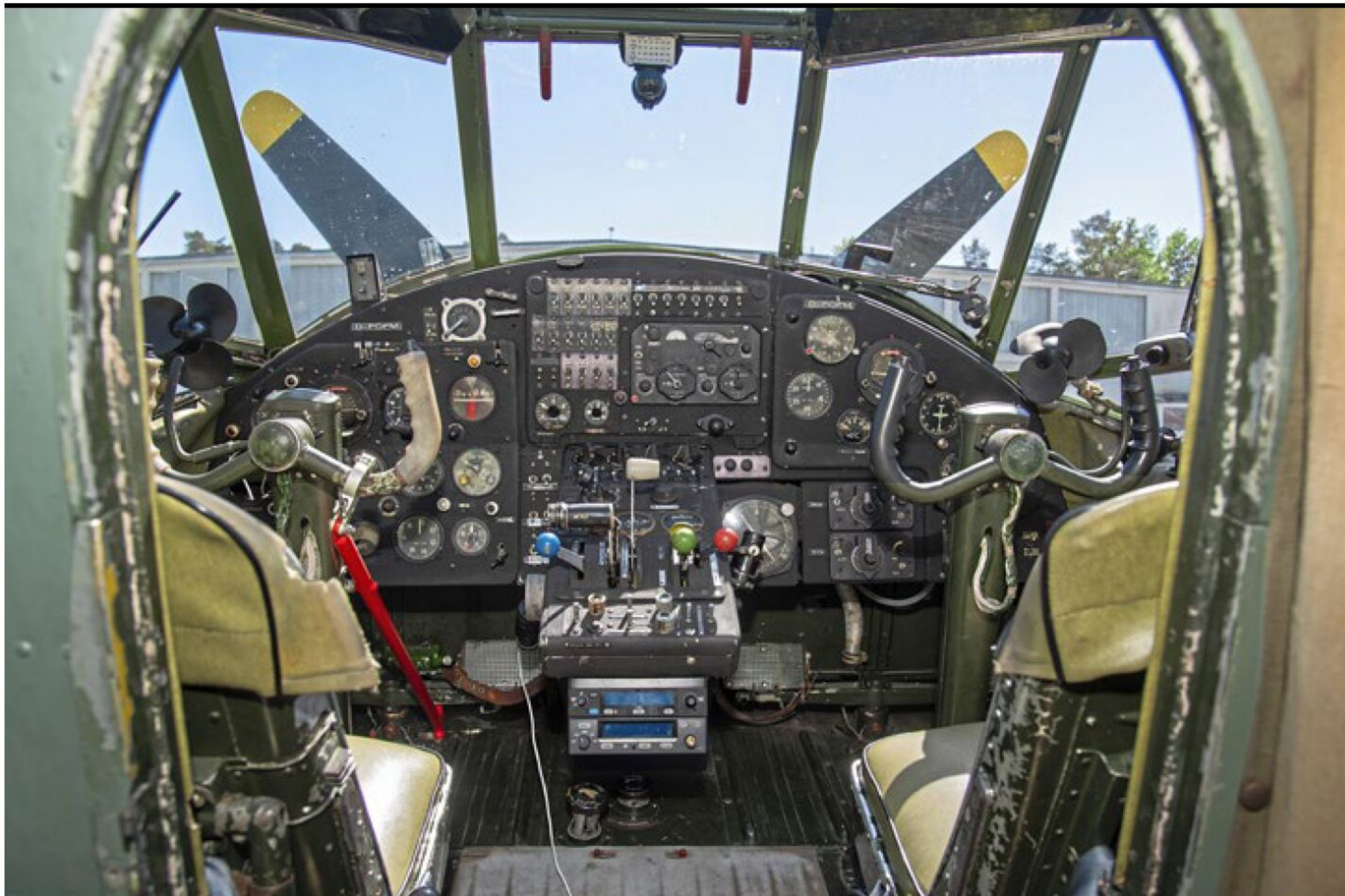
Das Cockpit ist weitestgehend im originalen Zustand. Zukünftig wird noch eine elektronische Motorüberwachung eingebaut werden, um das Triebwerk zu schonen.
