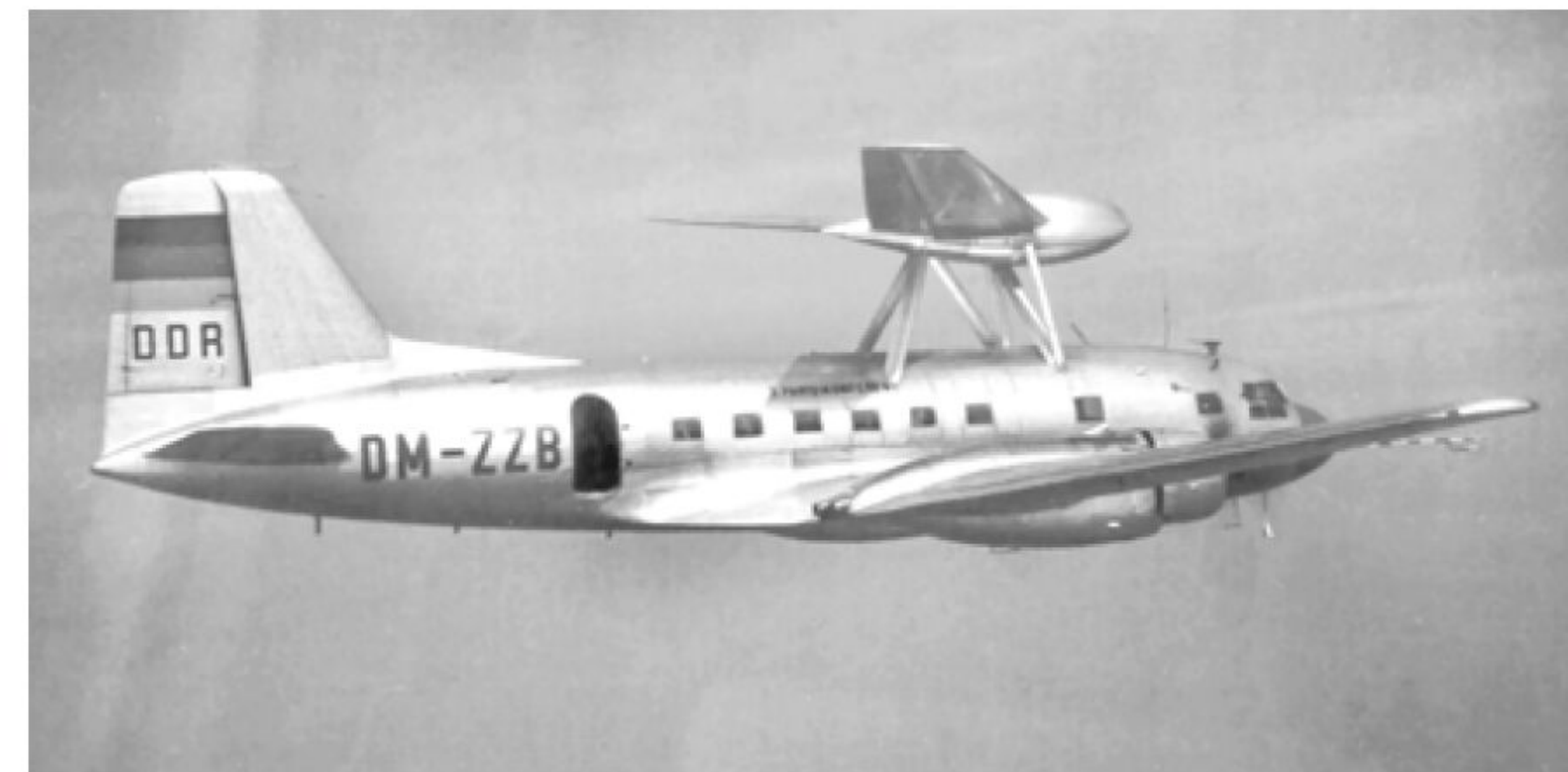
Testflug mit dem Höhenleitwerk der 152 auf einer Il-14P.
