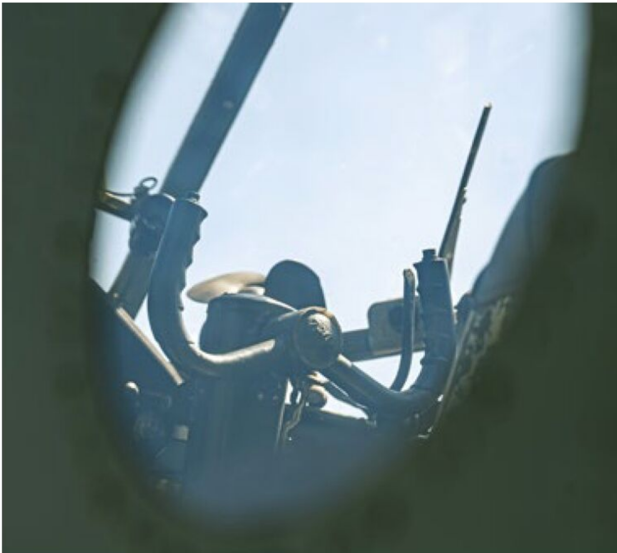
Die Bremsen werden über zwei Hebel am Steuerhorn bedient.
