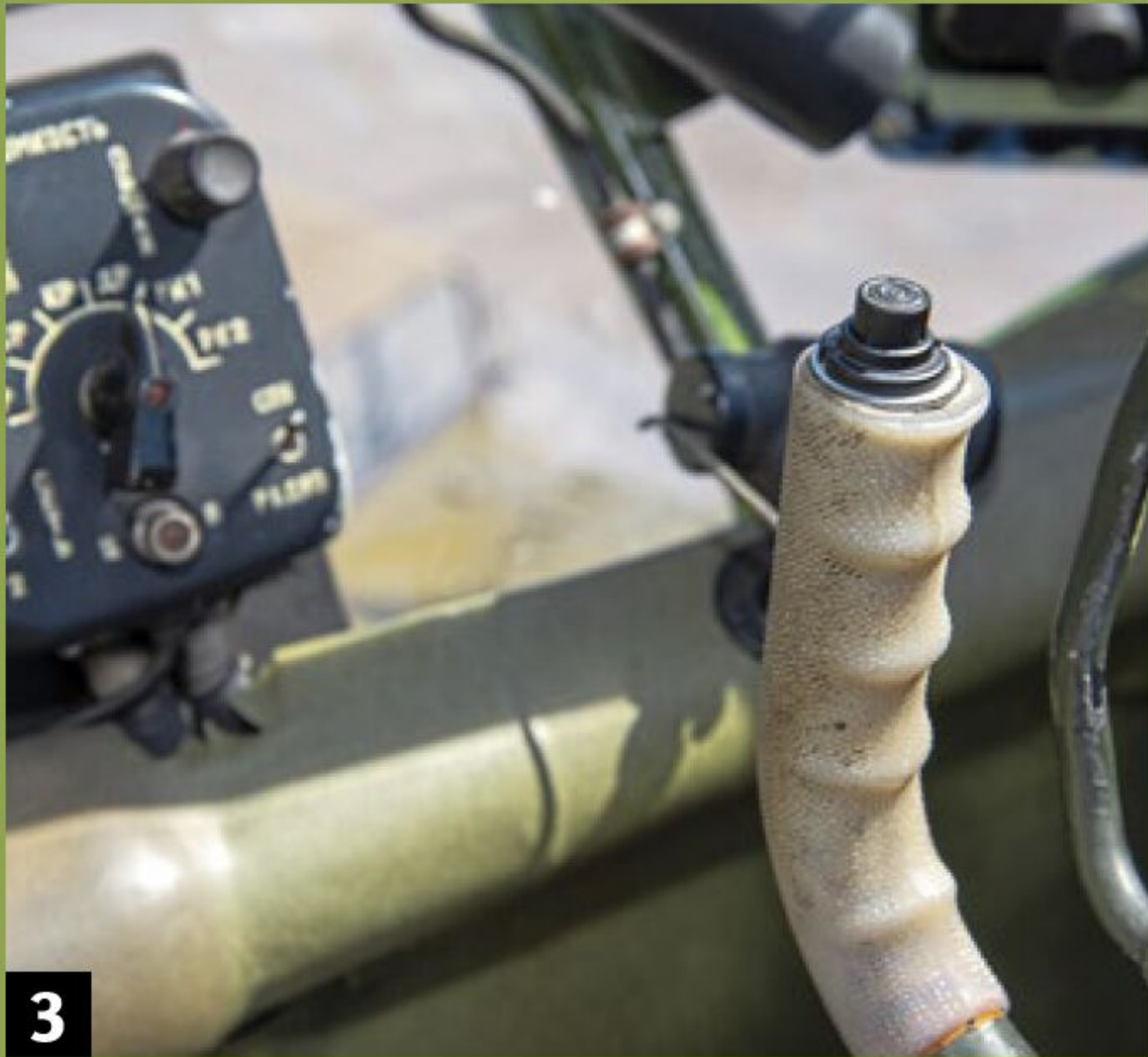
1 Klimaanlage à la Antonow: Kleine Ventilatoren versorgen die Crew mit Frischluft. 2 Alles im Blick: Der Neun-Zylinder-Sternmotor wird in der Mitte des Cockpits bedient. 3 Griffig: Die Steuereingaben erfolgen über ein Steuerhorn. Die Bewegung setzt die Anna sehr gemächlich um. 4 Zweisprachig: Einige der Instrumente sind auf Kyrillisch beschriftet.
