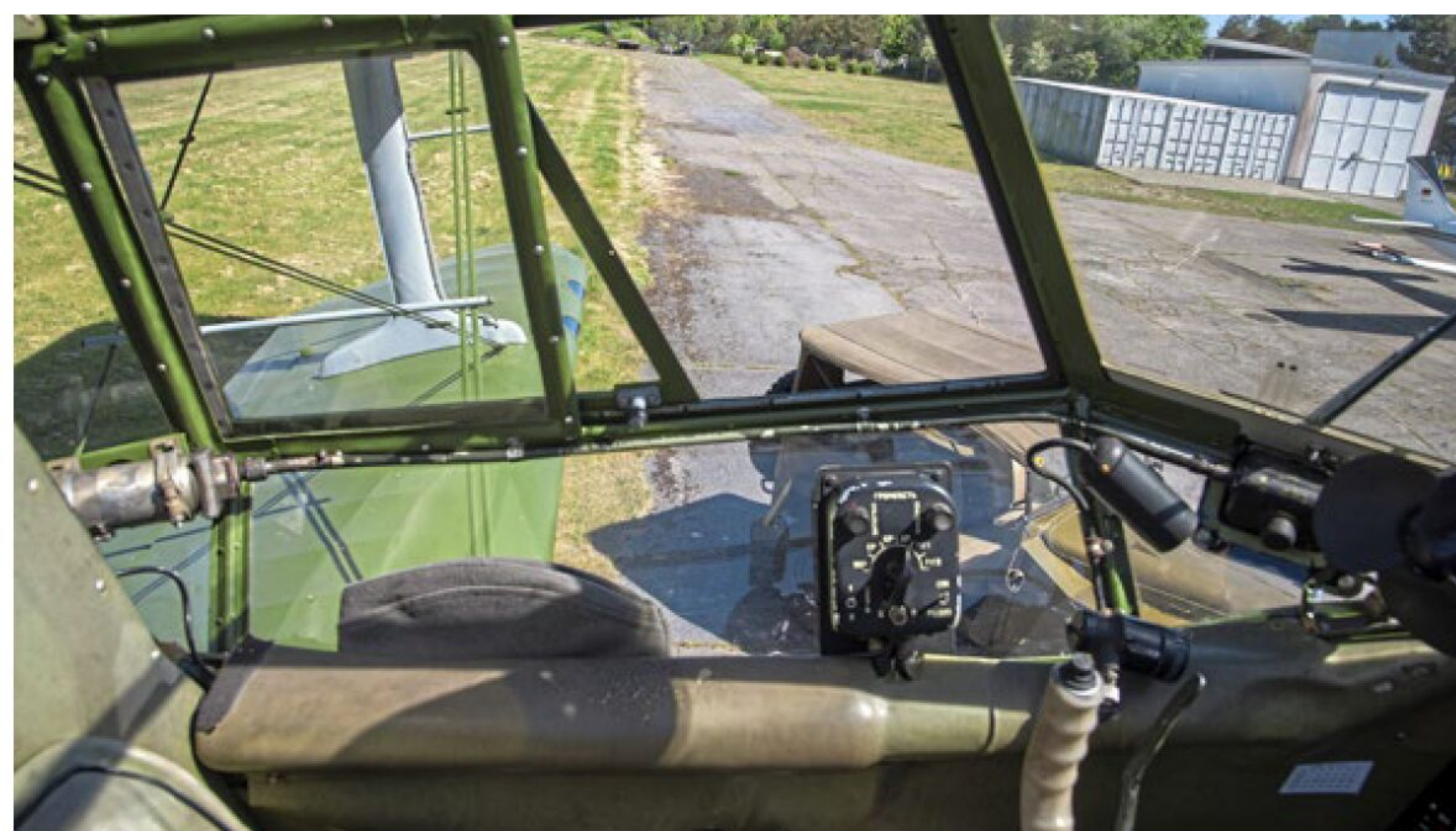
Auch die gesamte Verglasung im Cockpit und der Zelle wurde im Zuge der Restaurierung ersetzt und sorgt heute für perfekten Rundumblick.
