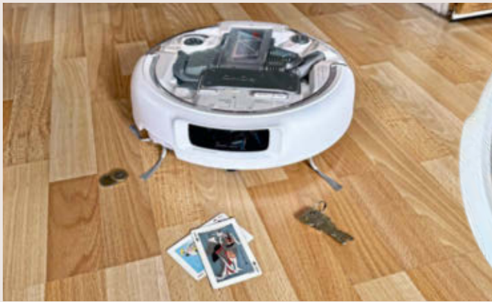
Der DJI Romo erkannte nahezu alle Hindernisse im Test. Er umschiffte neben Socken und Kabeln sogar kleinere Gegenstände wie Spielkarten und Schlüsselbund.
