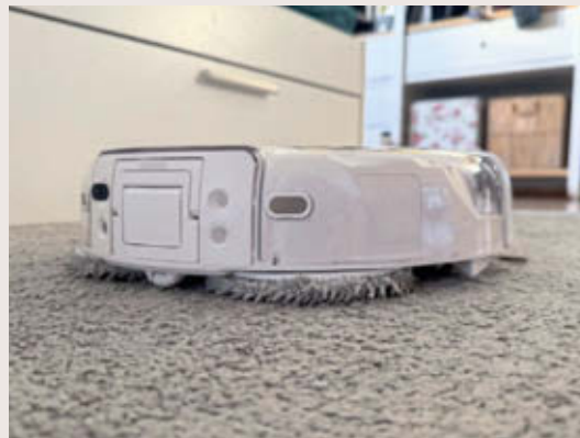
Das Wischen klappt ordentlich. Aber bei hohen Teppichen besteht das Risiko, dass die nassen Zotteln sie befeuchten.
