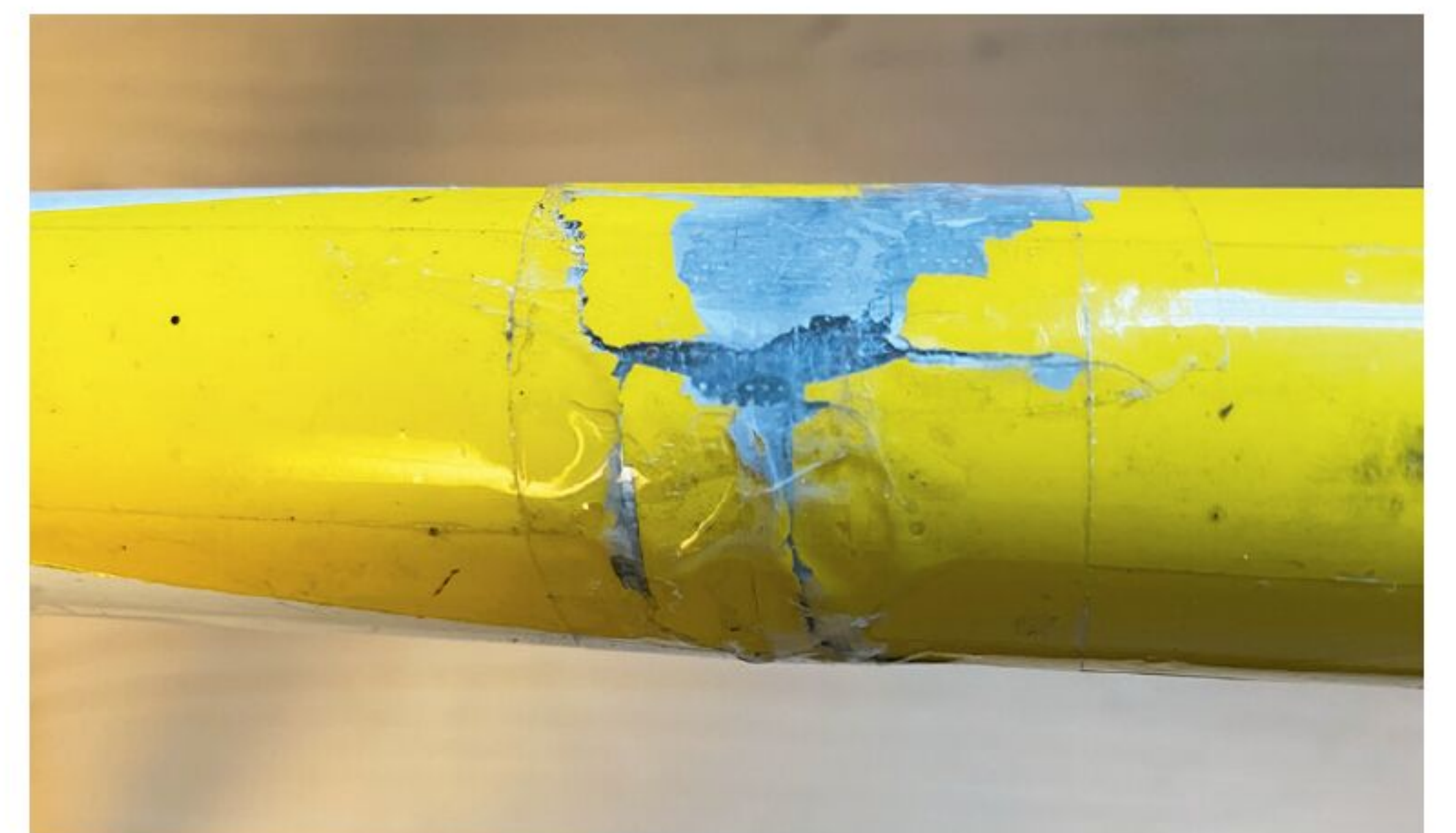
Ein »geschmierter Bruch« und die Ausrichtung eines frakturierten Heckauslegers nach dem provisorischen Verkleben mit Harz.
