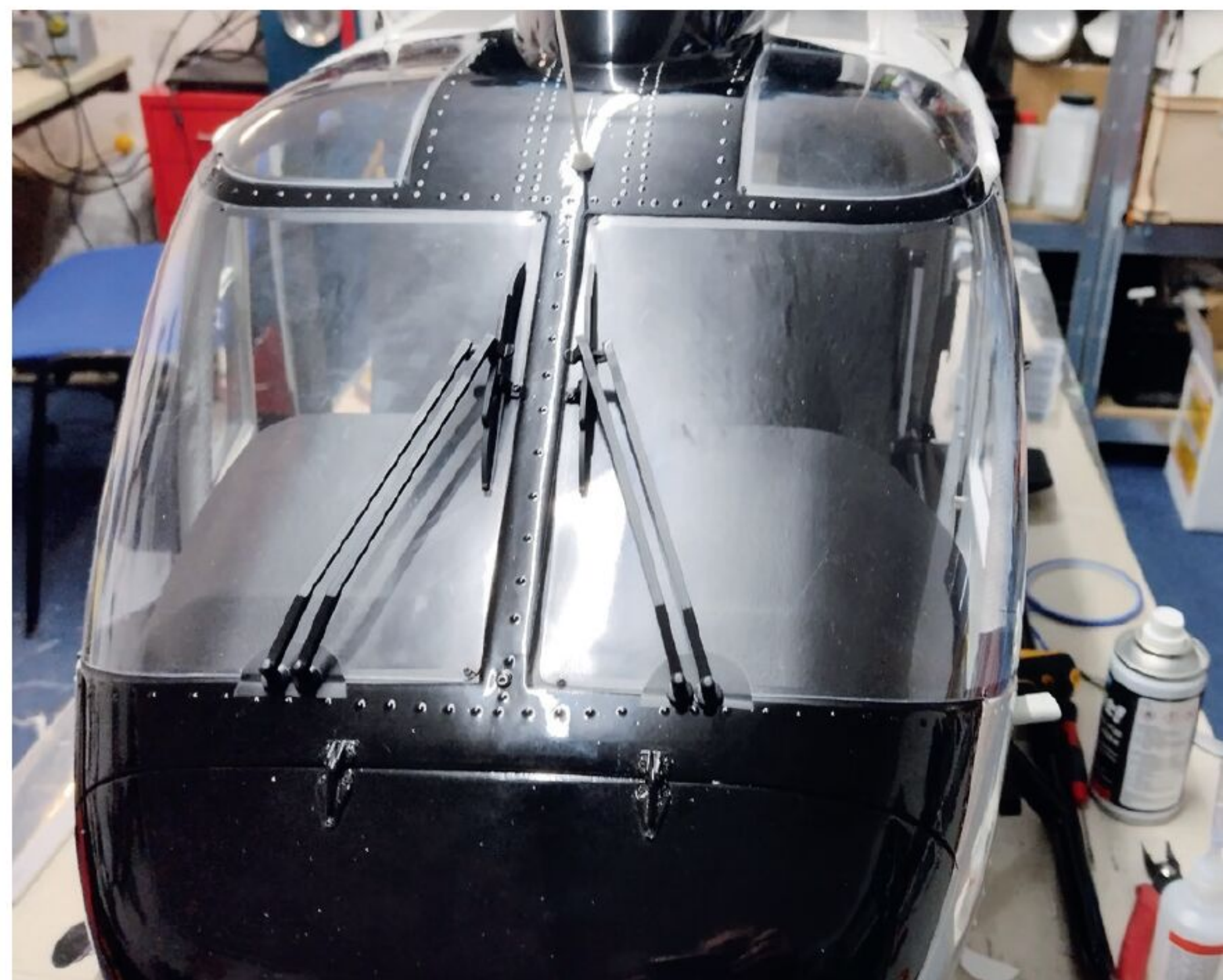
Die Scheibenwischer entstanden aus Teilen aus dem VARIO-Zubehörprogramm.
