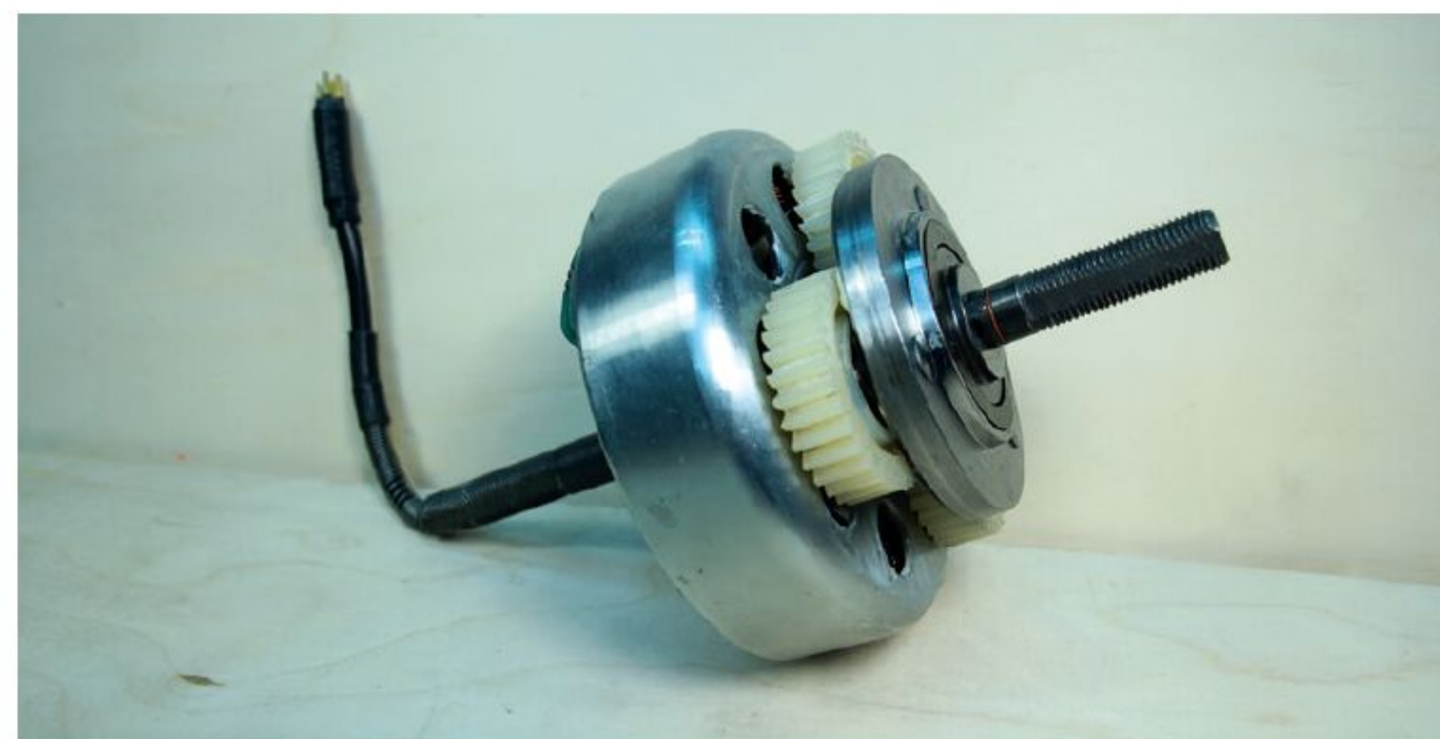
Der originale 48-Volt-Motor noch mit dem Planetengetriebe und der vollständigen Fahrradachse. So sehen die im Prinzip alle aus.
