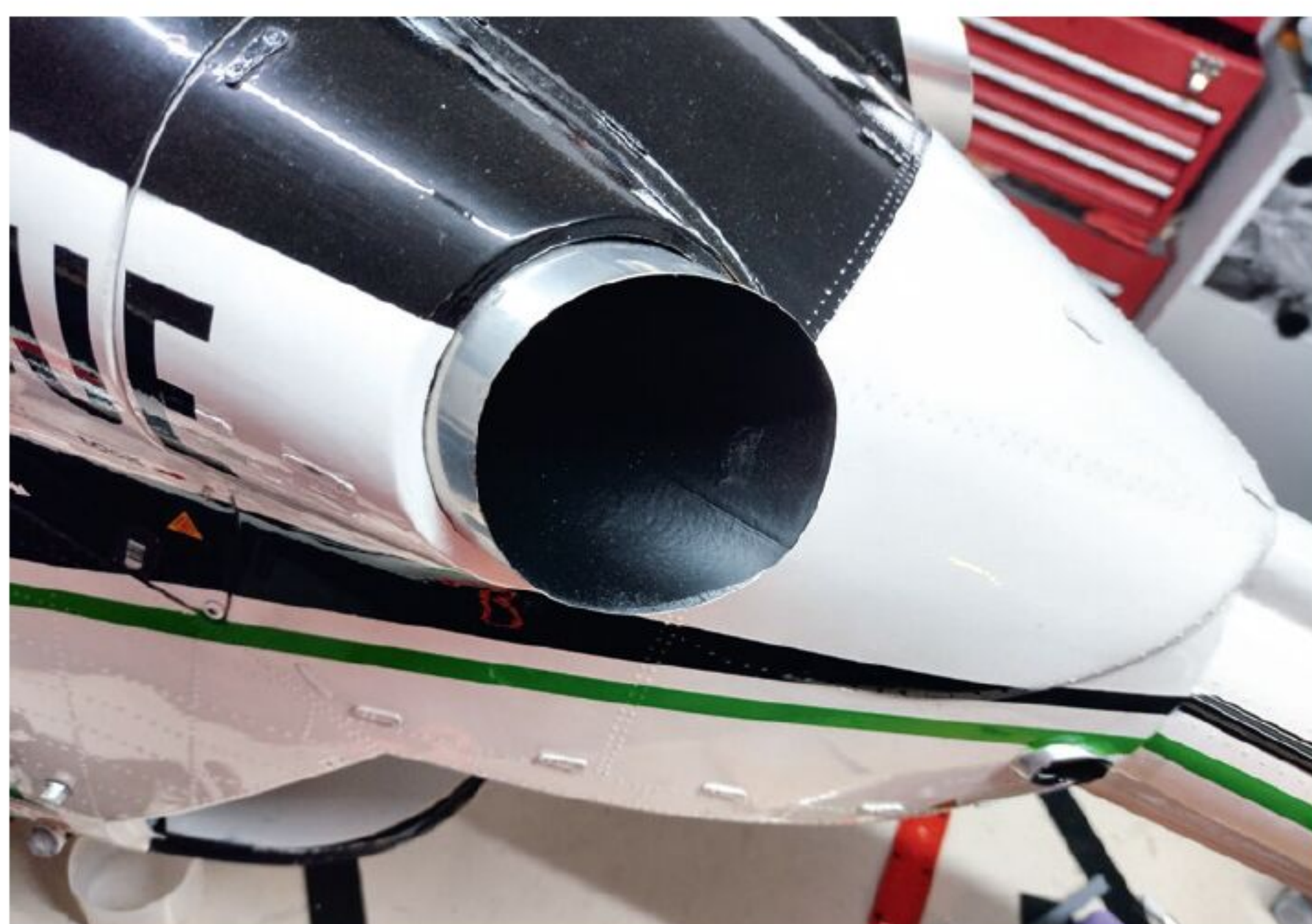
70-mm-Edelstahlrohr kommt am Turbinenauslass zum Einsatz.
