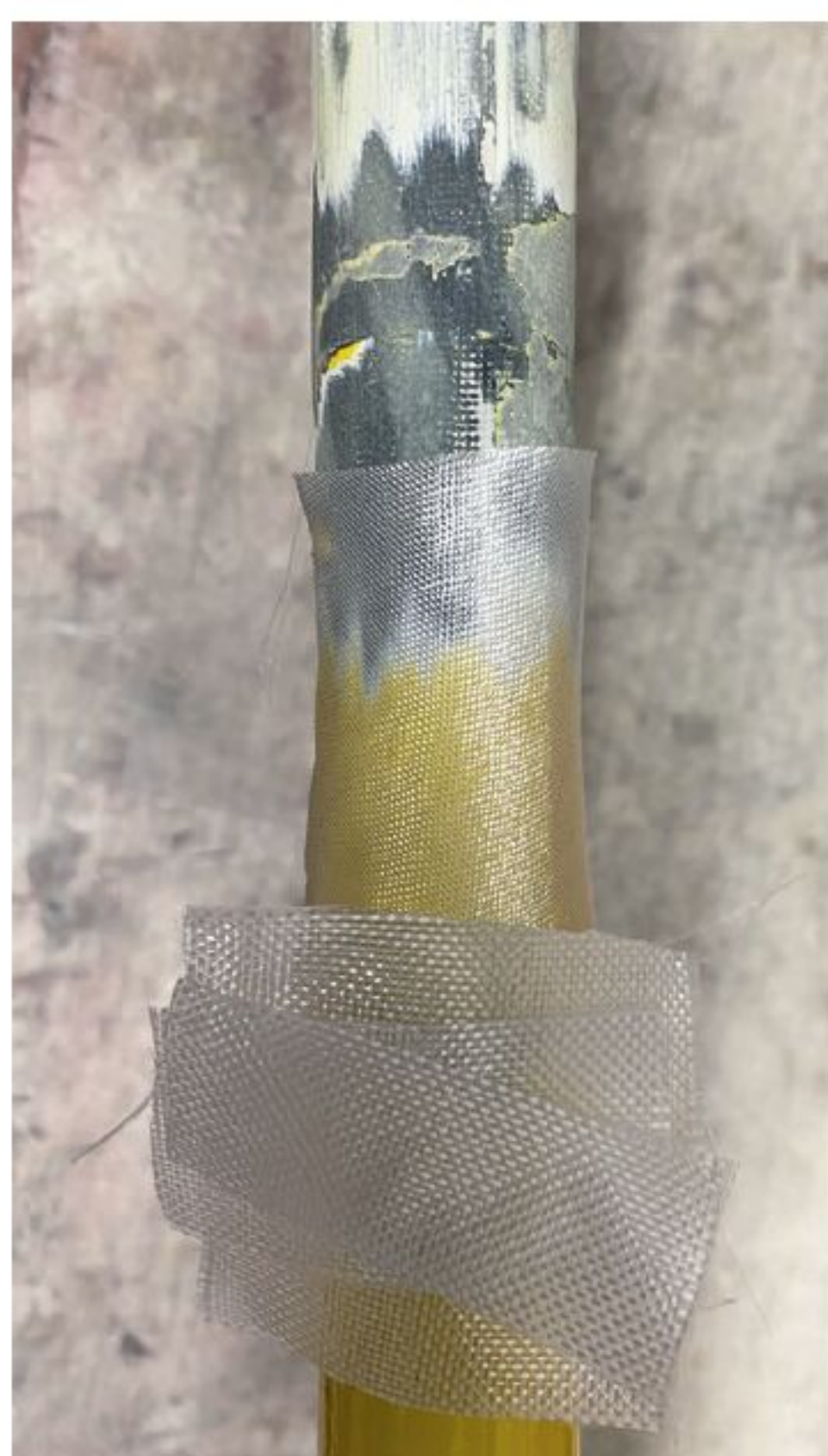
Mit Schleifklötzen vorbehandelter Bruch und zur Demonstration benötigte Gewebestücke.
