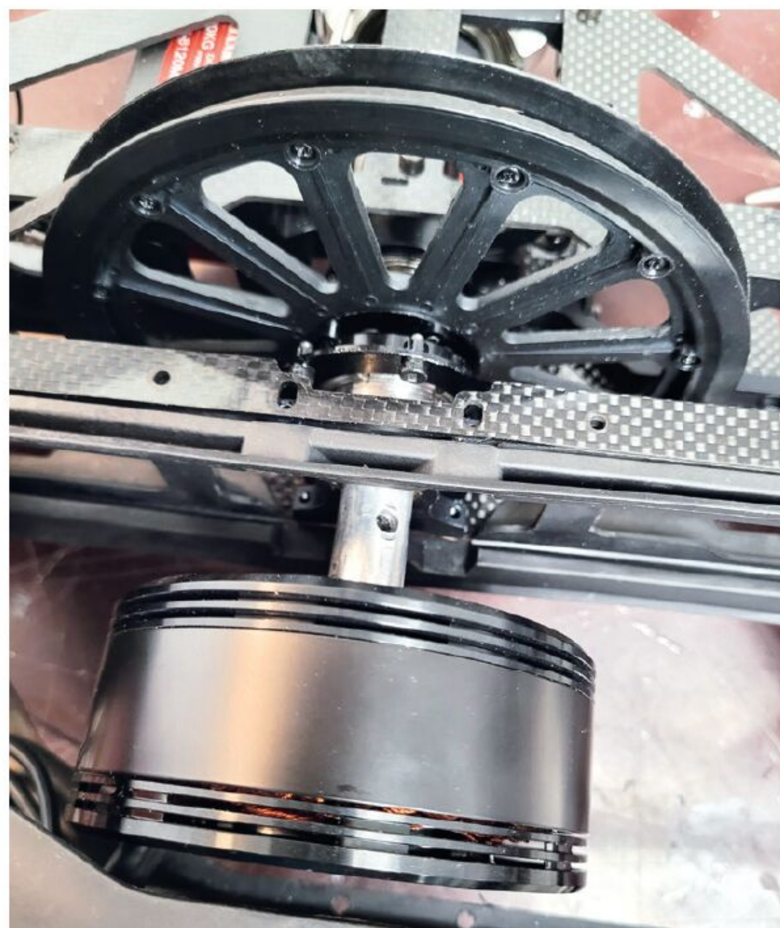
Bild ganz links: Der alte 800-kv-Außenläufer ragt etwas heraus und dreht den ebenfalls nicht originalen Dreiblatt-Heckrotor von SAB.
