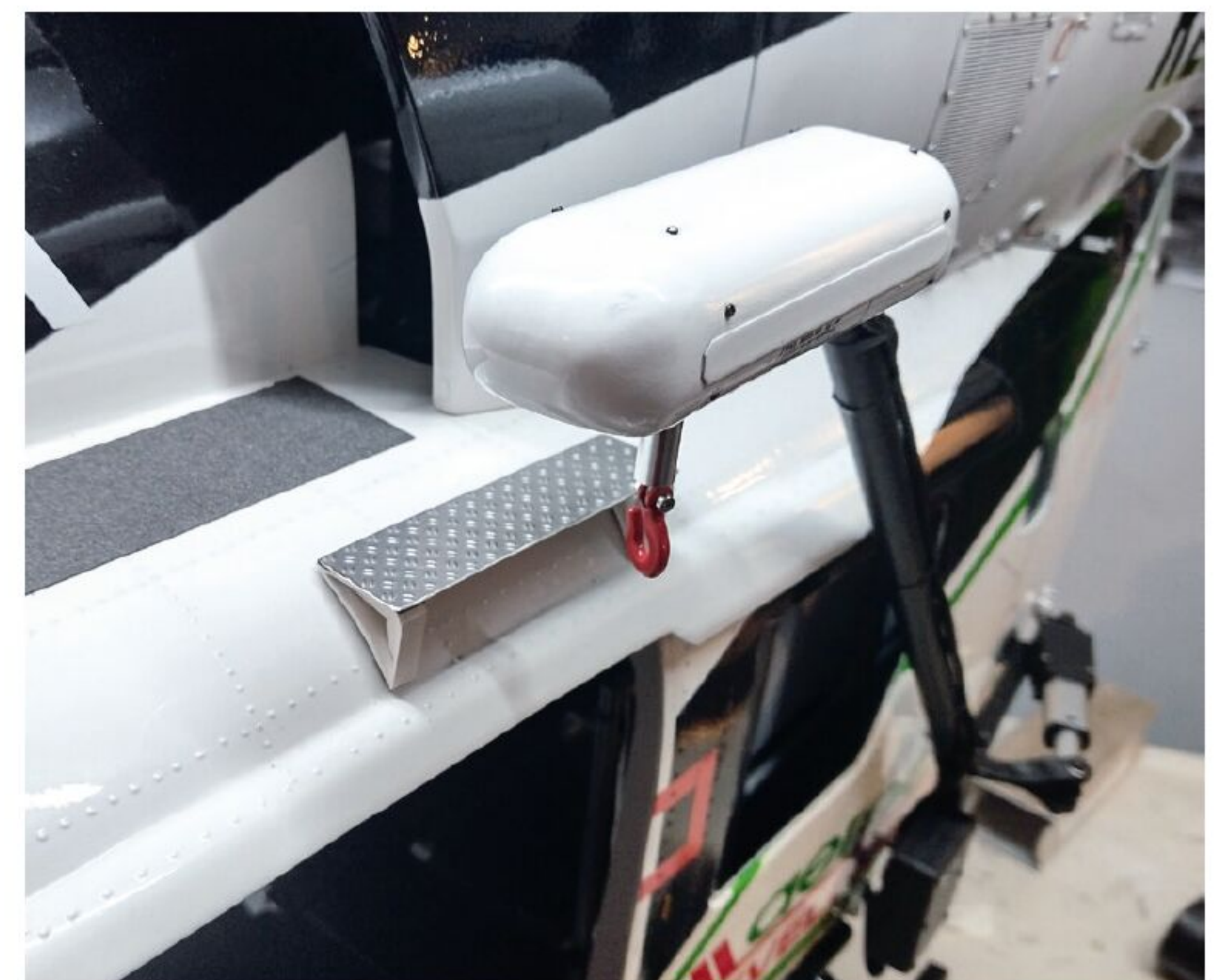
Das Trittbrett aus 4×4-mm-Kunststoff-T-Profil und Miniatur-Edelstahlriffelblech.
